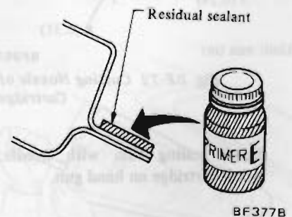
Fig. BF-70 Applying Primer E
